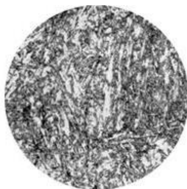
Рисунок.5.3 – Зерна мартенситу в сталі 4X5MФ1С, x1500
