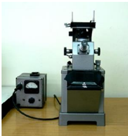
Рисунок 3.2 – Металографічний мікроскоп МИМ-7 (фото)
